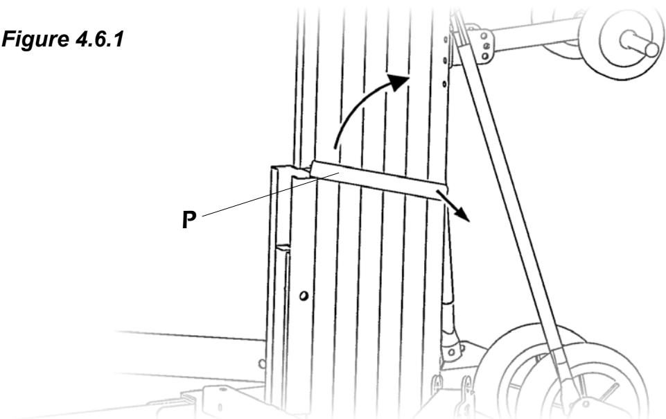
**4.7** – Déployez le lève-matériaux en tournant la poignée du treuil dans le sens des aiguilles d'une montre jusqu'à ce que le dernier mât en aluminium soit au-dessus de la base. Puis positionnez les fourches et placez-les en position horizontale contre le chariot de levage (les fourches doivent pointer vers le haut, jamais vers le bas), puis verrouillez les fourches avec les clavettes et les crochets (**Voir schémas 4.7.1 et 4.7.2**).
