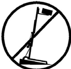
**3.2** - Il convient de placer le lève-matériaux sur une surface stable et plane. Toujours vérifier qu'il soit bien en position verticale sans inclinaison en s'aidant du niveau à bulle situé sur la base. Ajuster les pieds stabilisateurs en tournant les poignées pour mettre ce matériel à niveau si nécessaire. Ne jamais utiliser de cales ou tout autre objet pour mettre le lèvematériaux horizontal.
