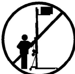
**3.8** - Ne pas déplacer le lève-matériaux lorsque celui-ci porte une charge à une hauteur supérieure à 30cm du sol. Il est déconseillé de procéder à tout type de déplacement horizontal, même pour de légers ajustements. Il ne faut déplacer le lève-matériaux que lorsque la charge est à la hauteur minimale.
