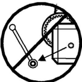
**3.16** - NUNCA desmontar la manivela del cabrestante cuando el elevador está soportando una carga o extendido.
