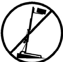
**3.2** - Colocar el elevador sólo en superficies firmes y planas, verificando que está en posición vertical, utilizando el indicador de nivel de burbuja que se encuentra en la base. Ajuste los estabilizadores girando las manivelas hasta nivelar, si es necesario. Nunca utilice cuñas u otros objetos extraños para equilibrar el elevador.
