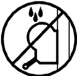
**3.14** - No engrasar ni lubricar el mecanismo de freno del cabestrante. Los discos de freno vienen engrasados con una solución especial resistente a la presión y al calor. No deben utilizarse otros productos, para evitar los efectos negativos sobre el mecanismo de frenado.
