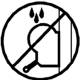
**3.14** - Ne pas graisser ou lubrifier le système de frein du système de frein du treuil. Les disques de frein ont été graissés avec une graisse spéciale résistant à la chaleur et à la pression. Il convient de ne pas utiliser d'autres produits qui pourraient affecter l'efficacité du système de frein.
