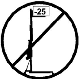
**3.15** - La charge minimale pour éviter tout problème avec le mécanisme de freinage est de 25kg. Le système de freinage ne fonctionnera pas avec un poids inférieur à 25kg.
