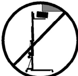
**3.10** – Faire attention en levant une charge à tout obstacle situé en hauteur, tels que des balcons, corniches, enseignes lumineuses. Il est très important d'empêcher la présence de câbles au-dessous du lève-matériaux en cours d'utilisation.
