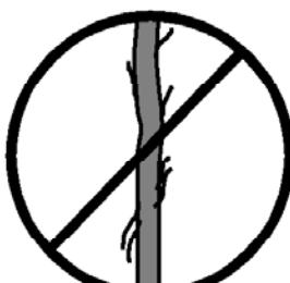
**3.12** - Avant d'utiliser le lève-matériaux, toujours vérifier l'état du câble. Si le câble est entortillé, usé, effiloché, endommagé ou s'il possède quoi que ce soit qui pourrait entraver sa rotation autour des poulies, ne pas utiliser l'appareil. Toujours utiliser des câbles fournis par le fabricant réf DIN3060. Qualité : 180kg/mm<sup>2</sup>.
