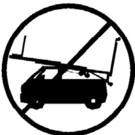
**3.13** - Antes de transportar la torre, todos los tramos deben ser bajados, y las patas deben colocarse en su posición de transporte.
