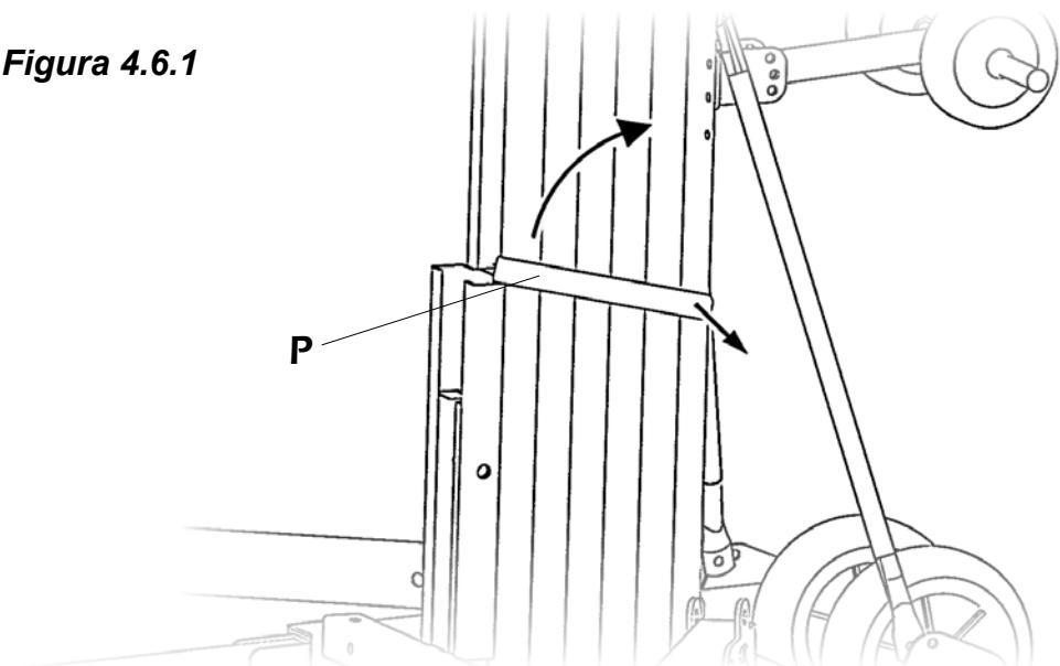
**4.7** - Eleve la torre girando la manivela del cabrestante en sentido horario hasta que se eleve el tramo final de aluminio por encima de la altura de la base. Ahora, libere los brazos de carga y colóquelos en posición horizontal (los brazos quedarán inclinados hacia arriba, nunca hacia abajo), para finalizar inserte los pasadores de seguridad con sus clips. (*Ver figura 4.8.1 y 4.8.2*).
