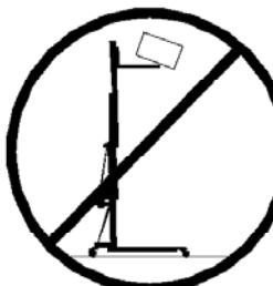
**3.4** - Ce lève-matériaux ne doit jamais être utilisé pour lever une charge qui n'a pas été vérifiée. Il est impératif de contrôler que la charge est correctement posée et centrée sur le support de levage qui convient afin que le poids de la charge soit levé parfaitement à la verticale.
