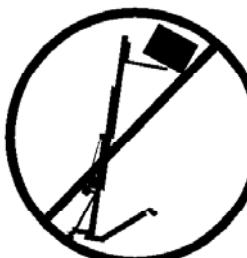
**3.5** - Vérifier que les jambes et les stabilisateurs soient correctement posés et installés et que les goupilles de sécurité soient insérées et verrouillées.
