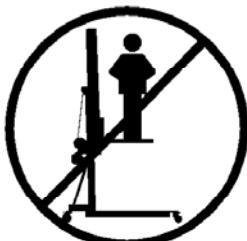
**3.1** - Le Hammer est un élévateur conçu pour lever des charges vers le haut dans une direction verticale; il ne doit pas être utilisé pour lever des personnes.
