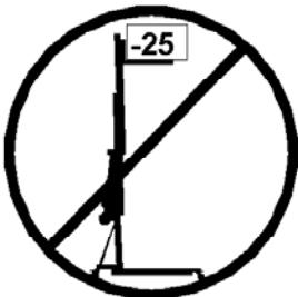
**3.15** - La carga mínima para evitar problemas relacionados con el mecanismo de frenado por rotura de cable es 25 kg. Sin esta carga mínima el freno no funcionará.
