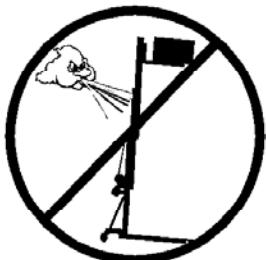
**3.7** – Ne jamais utiliser cet élévateur en cas de vents forts ou de bourrasques. Ne jamais attacher le matériel sur un véhicule ou tout autre dispositif mobile.
