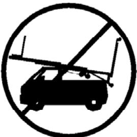
**3.13** - Avant de transporter le lève-matériaux, toutes les sections de mât doivent être descendues et les stabilisateurs doivent être remis en position de transport
